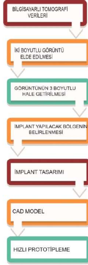
Şekil 1. Kişiye Özel İmplant Tasarımı ve Üretim Aşamaları
