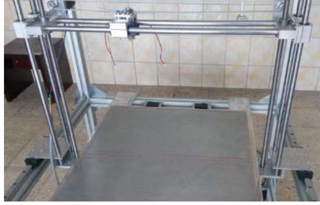
Şekil.4 Üç boyutlu yazıcı tabla ve hareket eksenleri montajı
