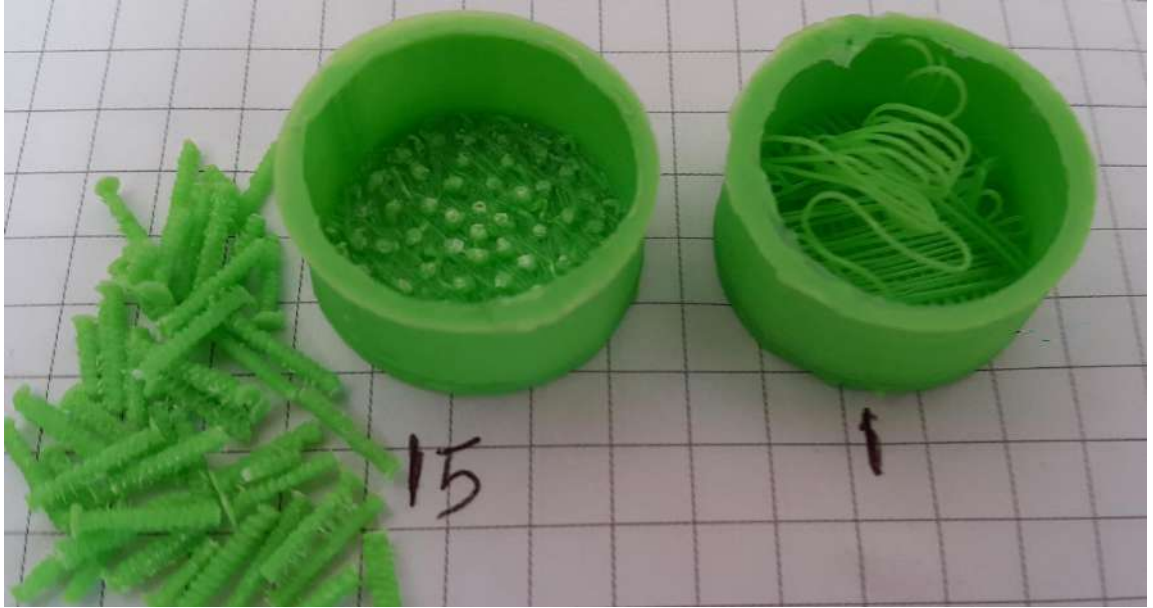
Şekil 6 Silindirik Prizmaların 15 ve 1 Numaralı Parçaların Yazdırılma Sonrası İç Bölgelerin Makro Görüntüleri
