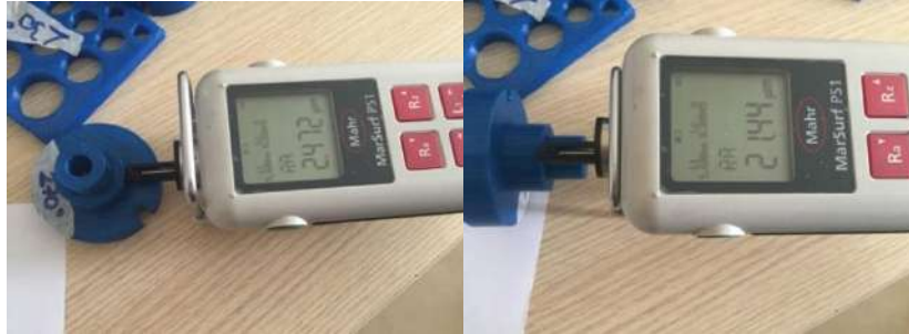
Şekil 6. Deneysel parçaların yüzey pürüzlülüğü ölçümü
