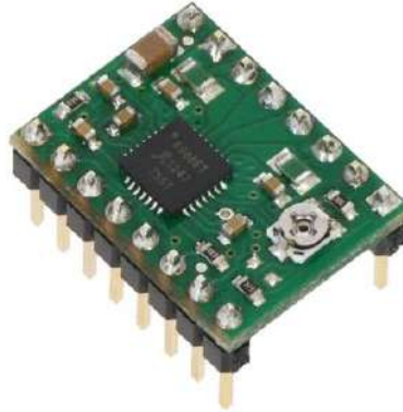
Şekil 6. Pololu adımı motor sürücüsü (A4988)
