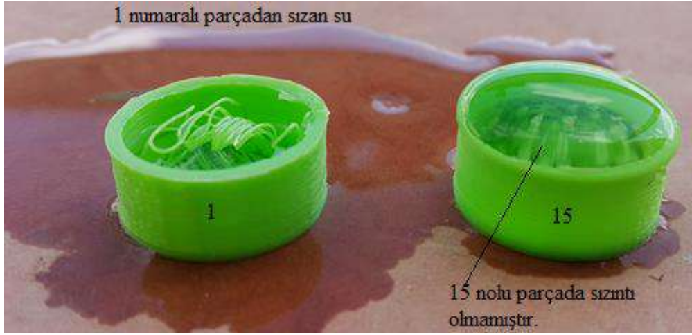
Şekil 7 Su Sızdırmazlık Testleri 1 ve 15 Numaralı Parçaların Görünümü.
