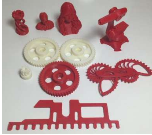
Şekil 18. ABS malzemesi kullanılarak 3D yazıcıda üretilmiş örnekler
