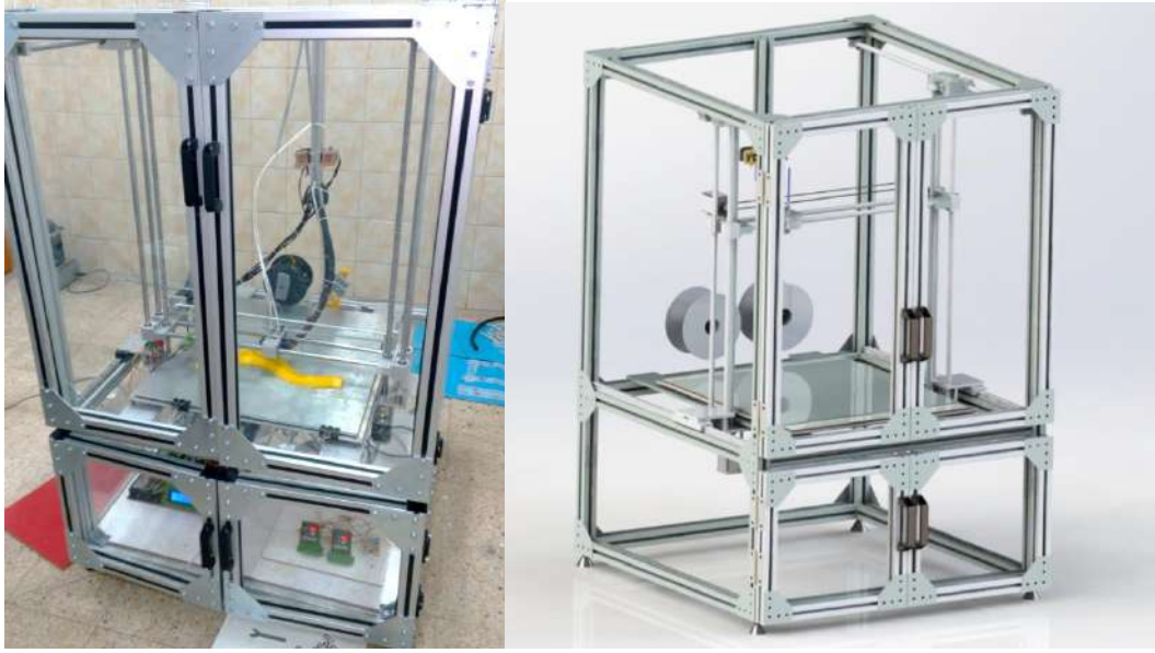
Şekil.1 Endüstriyel boyutlu çift başlı kartezyen tipi üç boyutlu yazıcı model ve prototipi
