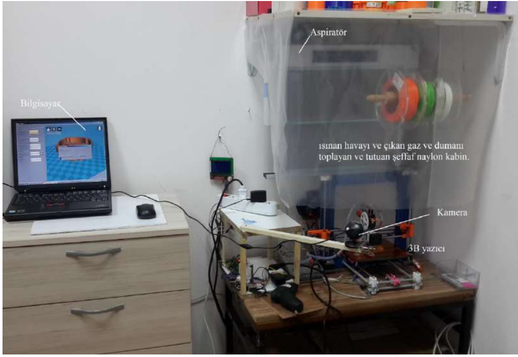
Şekil 2. Havalandırma ve sıcak hava toplama kabini düzeneği (düzenek 2).
