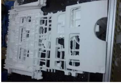
Şekil 11. Katmanlar ile EPS modelin oluşturulması, solda tüm katmanlar, sağda örnek kalıbın montajının temsili
