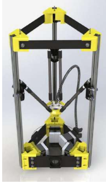
Şekil 3. Delta Tipi Üç Boyutlu Yazıcı [5].
