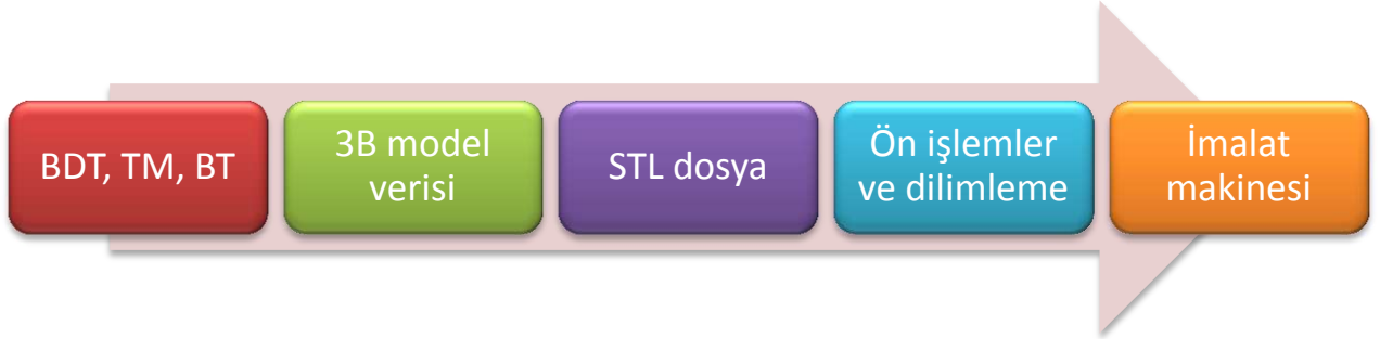
Şekil 1. Eklemeli imalat işlemi veri akışı
