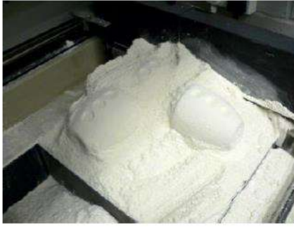
Şekil 1. SLS Makinesinde Seramiğin Üretilmesi (Huson. 2011:5)
