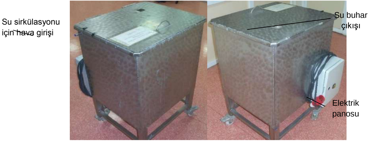
Şekil 15. Destek malzemesi çıkarma havuzu
