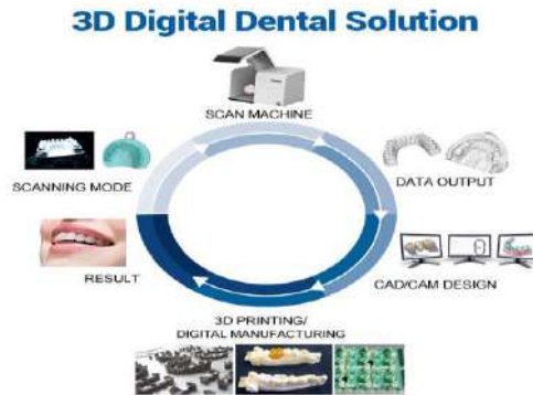
Şekil 3. İmplant üretim döngüsünün şematik gösterimi
