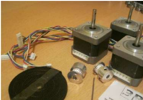
Şekil 3. Step(adım) Motorları Vekayış Kasnak Sistemi
