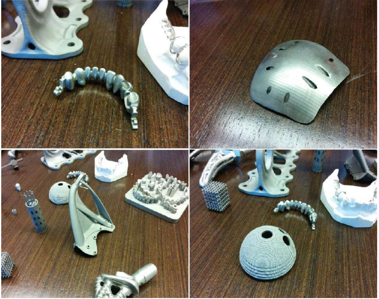
Şekil 9. DMLS Yöntemiyle Üretilmiş Parçalar [2].
