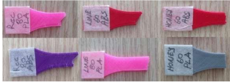
Şekil 9. Farklı dolgu stillerinin çekme deneyinde oluşan kopma yüzeyleri
