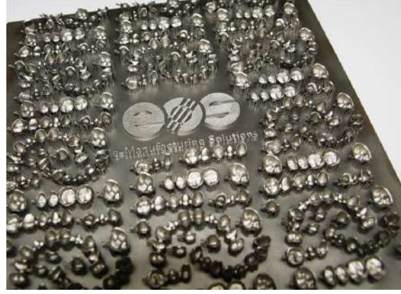
Şekil 10. İmalat tablası üzerinde üretim sonrası metal diş altlıkları.
