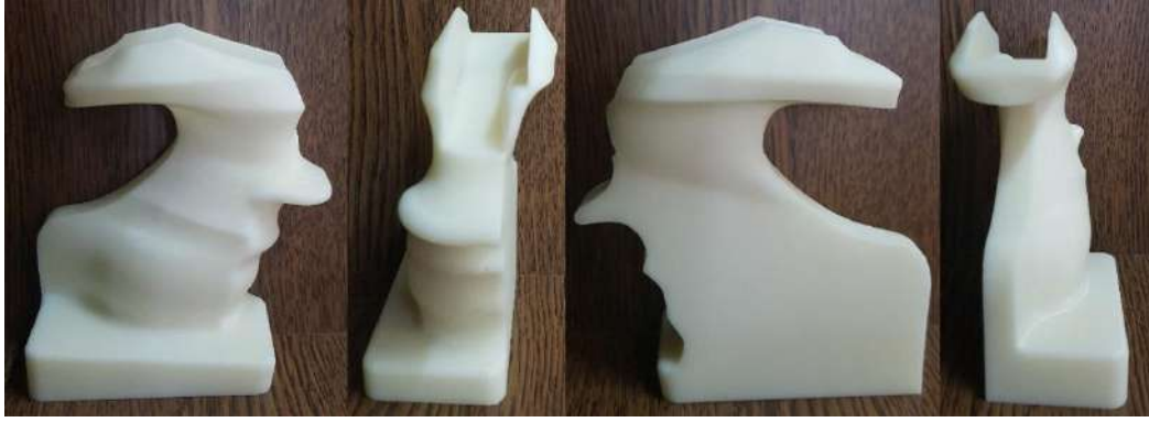
Şekil 4. Bayanlar için örnek olarak tasarlanmış ergonomik havalı tabanca kabzasının 3B yazıcı kullanılarak üretilen prototipi
