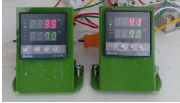
Şekil.8: Tabla sıcaklığının PID ile sabitlenmesi ve anlık sıcaklık ölçümü
