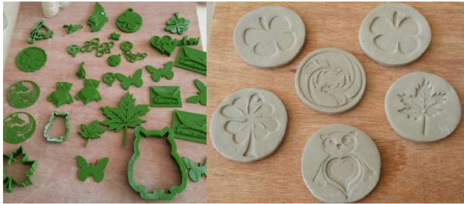
Şekil 19. PLA malzemesi kullanılarak 3D yazıcıda üretilmiş kalıp ürünler ve bu ürünlerden elde edilmiş nihai ürünler
