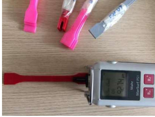
Şekil 6. Yüzey pürüzlülüğünün ölçülmesi
