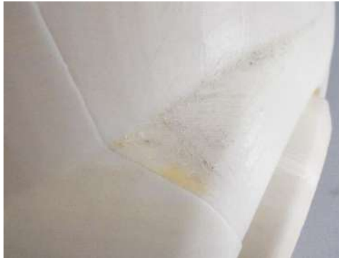
Şekil 8. Prototip imalatından sonra destek malzemenin çıkartılmasında oluşan deformeler
