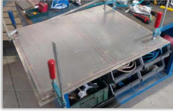
Şekil.5: Tabla tüm plakaların montajı
