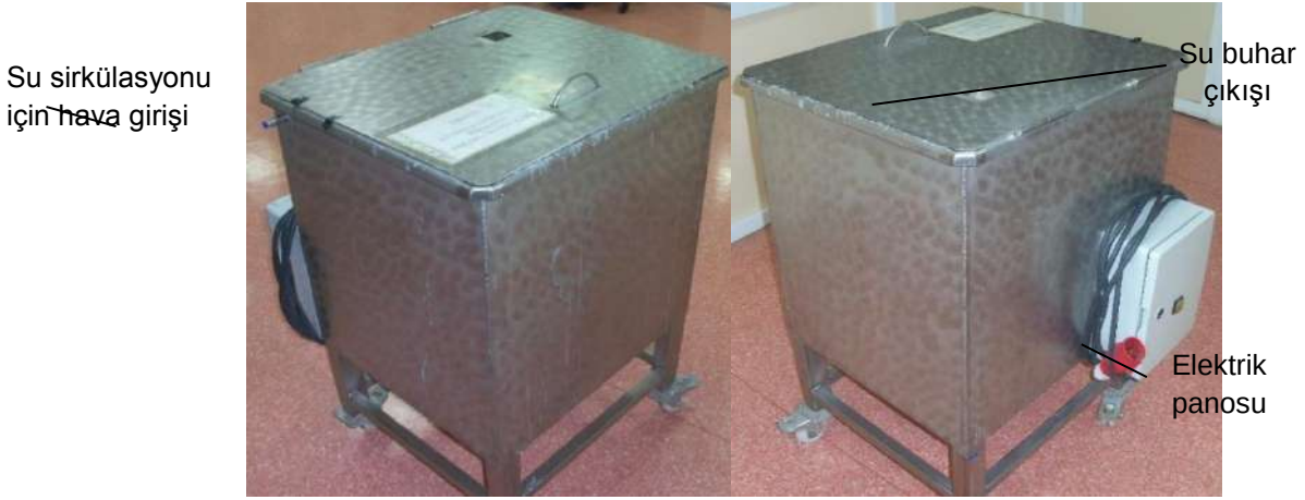
Şekil 15. Destek malzemesi çıkarma havuzu
