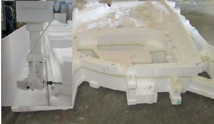
Şekil 3. Ütöleme kalıbı ve içi dolu EPS kütükten kalıp çeliğinin işlenmesi (solda), Trim kalıpları için ayrı ayrı işlenen çelik modelleri (sağda)
