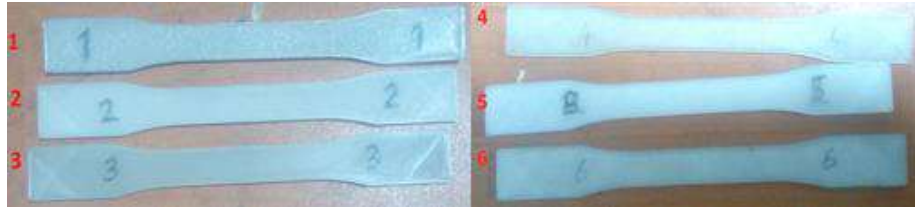
Şekil 9. 3BYazıcıdan baskı alınan üretilmişve ticari PLA malzeme çekme numuneleri
