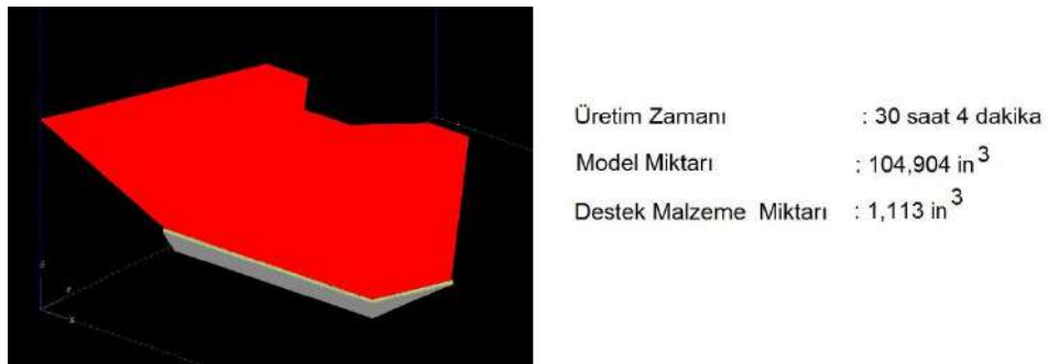
Şekil 17. Konumu değiştirilmiş parçanın destek malzemesi, parça takım yolları ve parça üretim teknik verileri
