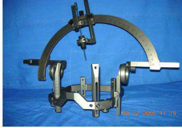
Şekil 5. LarsLeksell'in ark-kadran prensibine dayanan stereotaksi cihazı
