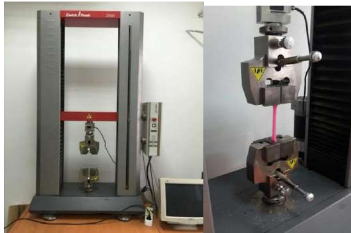
Şekil 2. Zwick Roell Z050 çekme cihazı ve deneyin yapılışı
