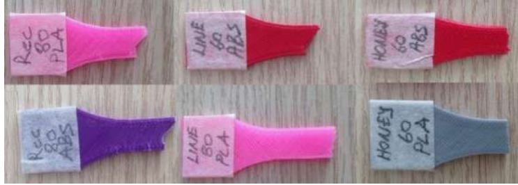
Şekil 9. Farklı dolgu stillerinin çekme deneyinde oluşan kopma yüzeyleri
