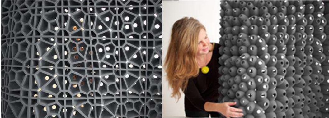
Şekil 5. 3D Printed House 1.0 için üretilmiş transparan iç ve dış duvar prototipleri [17]
