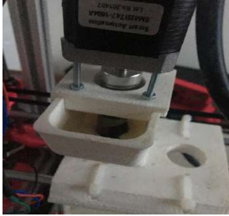
Şekil 4. Çift Nozullu 3B Yazıcı Ekstrüzyon Sistemi
