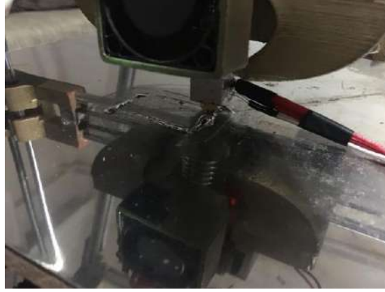
Şekil 16. Kartezyen 3B lehim yazıcı ile lehim yazdırma işlemi
