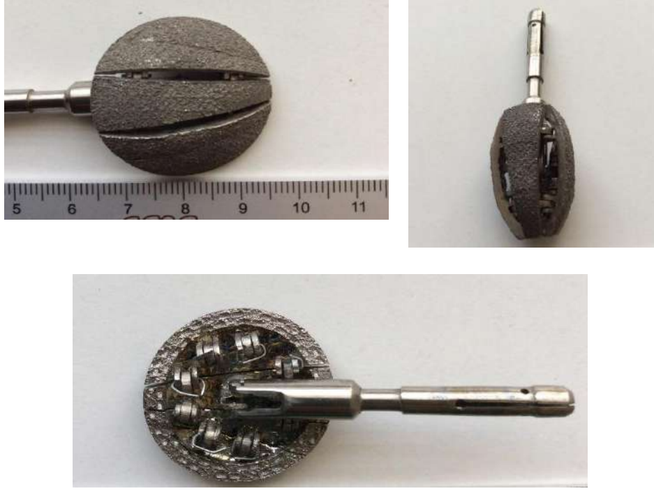
Şekil 7. SLS 3D printer ile üretilen 5 parçalı katlanabilir anvil
