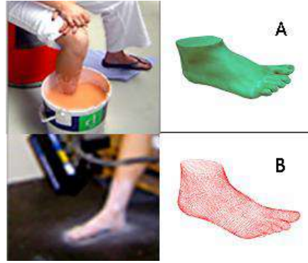
Şekil 10. (a) Balmumu kalıp elde edilmesi (b) 3B nokta bulutu [18]
