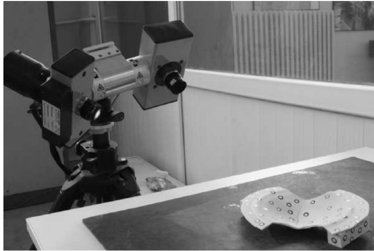
Şekil-3 Nakajima numunelerinin optik tarama cihazı ile taranması
