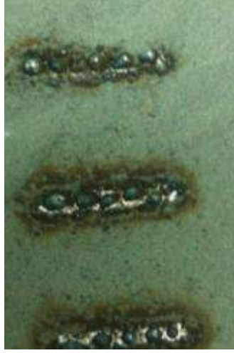
Şekil 10. Düşük tarama hızlarında toplamanın meydana gelmesi (lazer gücü 100w, tarama hızı 40-50-60 mm/s)
