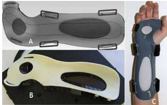
Şekil 14. (a) Ortezin 3B modeli, (b) 3B yazıcı ile imal edilen ortez, (c) ortezin kullanımı [23]
