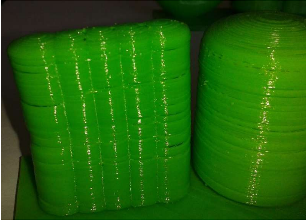
Şekil 4. Aşırı aseton buharına maruz kalmış PLA parça görüntüsü.
