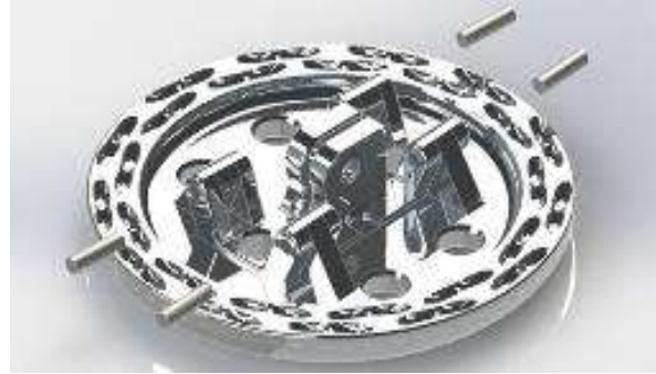
Şekil 6. Statik yükleme altındaki anvil üzerinde oluşan stress dağılımı ve modifiye edilmiş tasarım.
