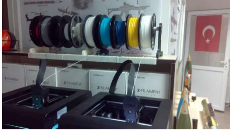
Şekil 11. Tasarlanan tutucu sistemin çalışma anı görüntüsü
