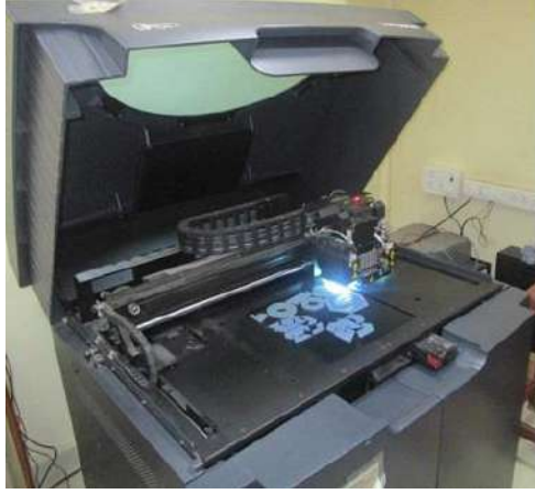
Şekil 6: PolyJet / InkJet 3D yazıcı örneği ve şematik gösterimi
