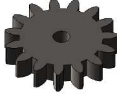
Şekil 3. Modül 3 15 diş sayısına sahip düz dişli çarkın CAD 3 boyutlu çizim görüntüsü.
