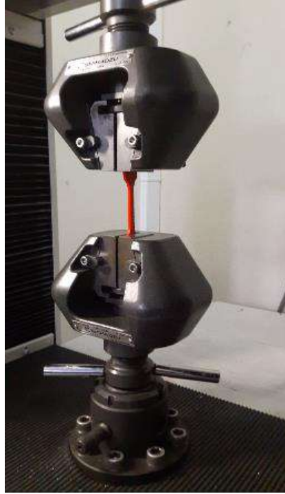
Şekil 5. 3D Printerda üretilmiş numunenin çekme testi
