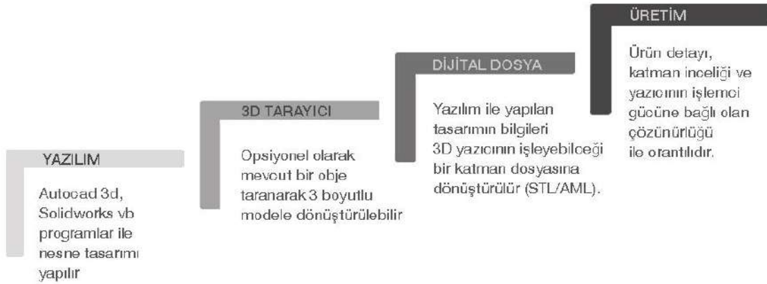
Şekil 1. 3 Boyutlu Baskının Genel İşleyişi [7].
