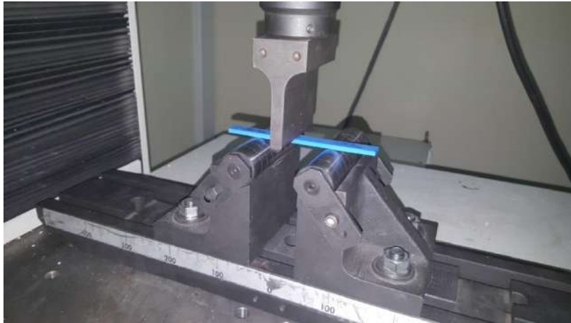
Şekil 6. 3D Printerda üretilen numunenin eğme testi
