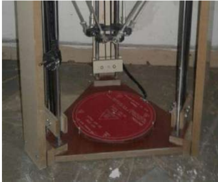
Şekil 7. Silindirik taşıyıcı sütun ve bağlantı plakaları
