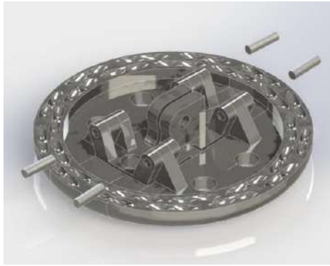
Şekil 4. Üç parçalı katlanabilir anvil detay tasarımı
